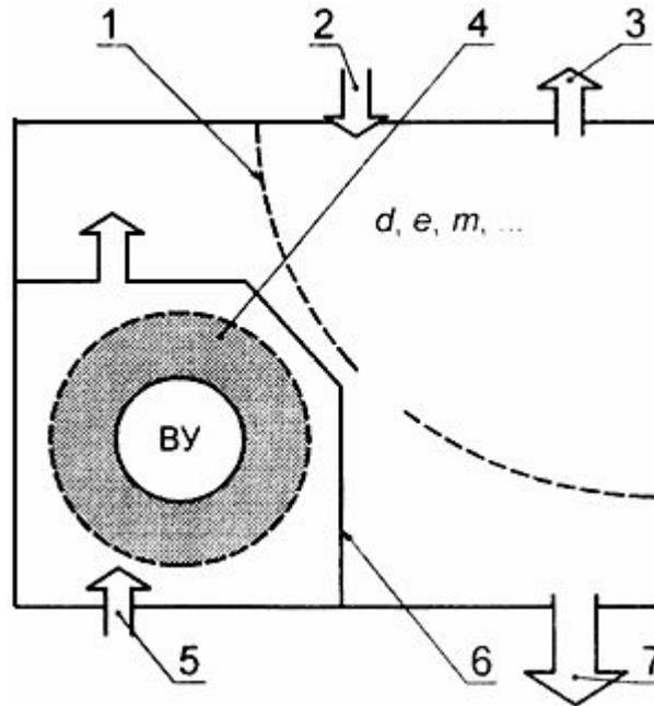
1 - номинальная граница зоны разбавления; 2 - вход воспламеняющегося вещества; 3 - выход воспламеняющегося вещества; 4 - испытание зоны разбавления; 5 - вход продувочного газа; 6 - перегородка оболочки воспламеняющего устройства; 7 - выход продувочного газа
