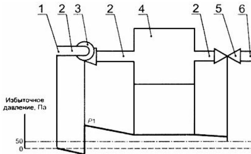
1 - вход защитного газа; 2 - газопровод; 3 - вентилятор; 4 - оболочка; 5 - выходной клапан;
