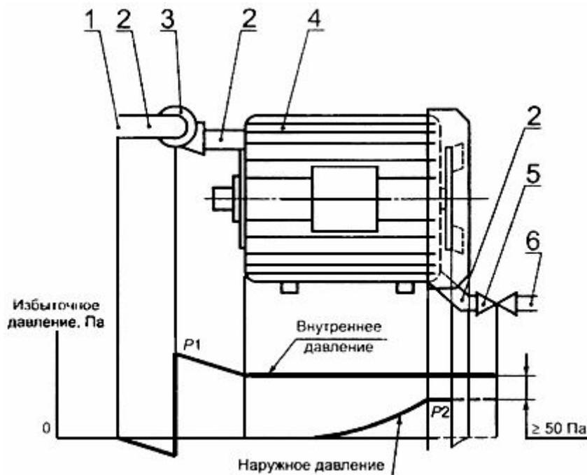
1 - вход защитного газа; 2 - газопровод; 3 - вентилятор; 4 - оболочка; 5 - выходной клапан;
