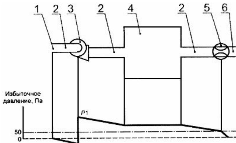
1 - вход защитного газа; 2 - газопровод; 3 - вентилятор; 4 - оболочка; 5 - дроссельная заслонка; 6 - выход защитного газа; P1- давление защитного газа.
